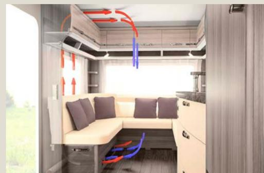
Tutti i pensili ed i vani di stivaggio sono ventilati in maniera perfetta, questo permette una libera circolazione dell'aria, evitando così la possibilità che si creino zone umide. Questo, permette inoltre che si crei all'interno dell'ambiente una temperatura uniforme e sana.
