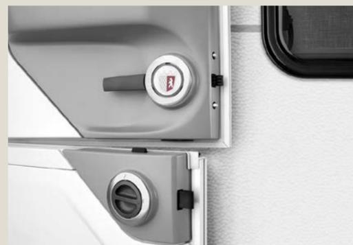
La porta d'ingresso è perfettamente integrata nel telaio grazie alle sue cerniere metalliche che permettano un'ottima chiusura, senza spifferi. La chiusura a tre punti garantisce una sicurezza ottimale.
